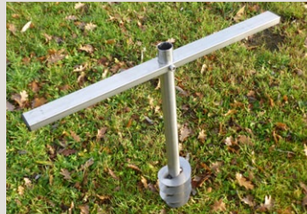
Indraai sleutel 50 x 20 mm, L=750 mm
